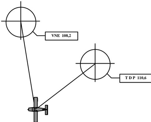
Une plus grande précision est obtenue en utilisant 2 VOR permettant de trouver sur quelle intersection se situe l'appareil.
